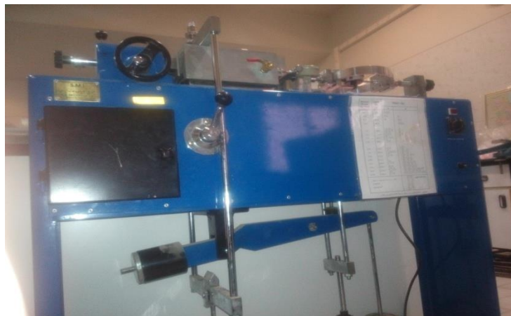
دستگاه تعیین پارامترهای برشی خاک
