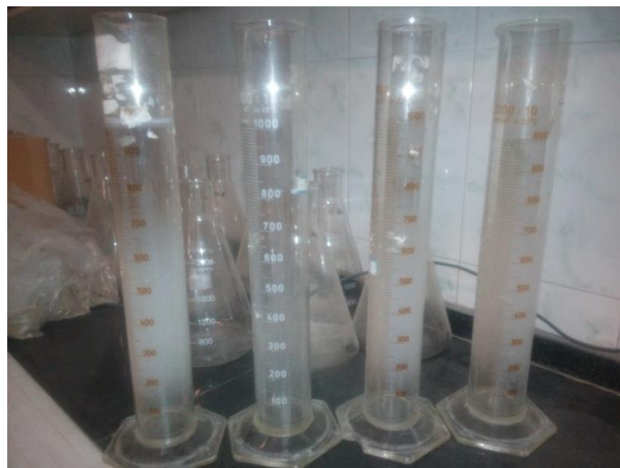
استوانه های مدرج آزمایش هیدرومتری
