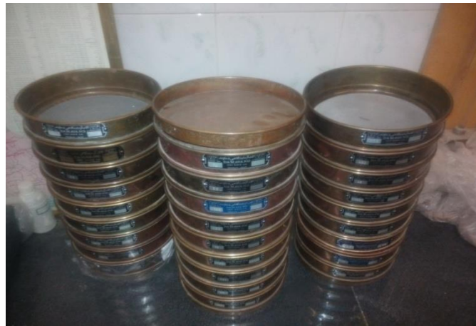
الک های آزمایش دانه بندی خاک
