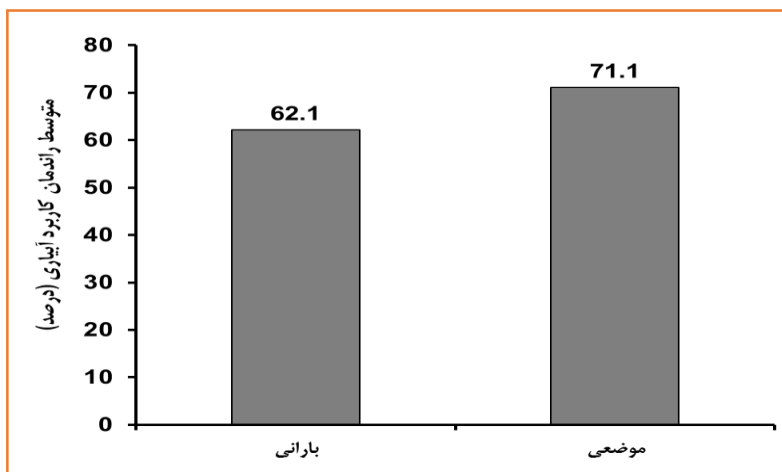
شکل ۲۴- مقایسه متوسط راندمان کاربرد در روش‌های آبیاری بارانی و موضعی
