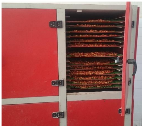
شکل ۳-۲- خشک‌کن قفسه‌ای برای خشک کردن سنجد. (ضیاءالحق، ۱۳۹۸)
