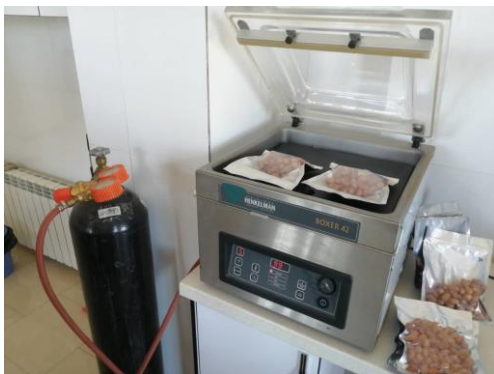
شکل ۲-۱۶- دستگاه بسته‌بندی تحت خلأ مدل باکسر ۴۲ ساخت شرکت هنکلن هلند همراه با کپسول گاز نیتروژن برای تزریق گاز (ضیاءالحق، ۱۳۹۹)
