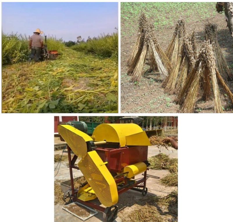
شکل ۳۲. برداشت دو مرحله‌ای کنجد شامل دروشدن، خشک شدن بوته‌ها و خرمکوبی. عکس - ها از کایلاشکومار (۲۰۲۱).
