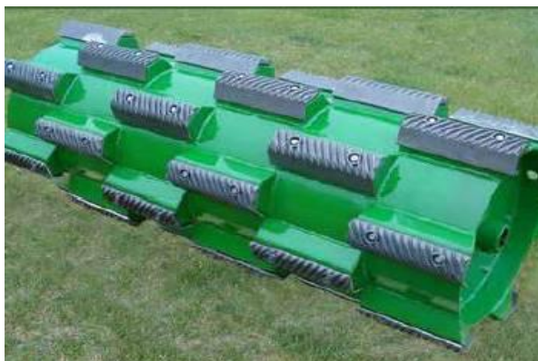
شکل ۴۶. کوپنده دندان‌ه سوهانی مناسب برای برداشت کنجد است اما اگر دارای لبه‌های تیز باشد باعث ایجاد آسیب به دانه‌ها می‌گردد. عکس از رستمی (۱۳۹۷).
