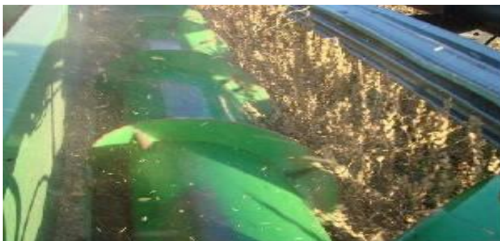
شکل ۳۰. وجود گرد و غبار در دماغه کمباین در حال کار حاکی از درصد رطوبت مناسب بوته‌ها و زمان صحیح برداشت است. عکس از لانگهام و همکاران (۲۰۱۰).
