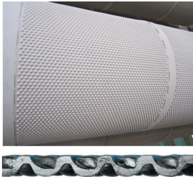
شکل ۵- نمای بیرونی و مقطع عرضی حفره های خرده گیر بذر گندم در استوانه دندانه‌دار
