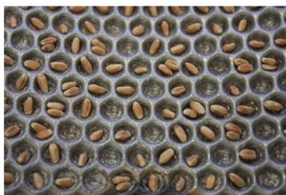
شکل ۶- نمای بیرونی و مقطع عرضی حفره‌های جوگیر بذر گندم در استوانه جوگیر
