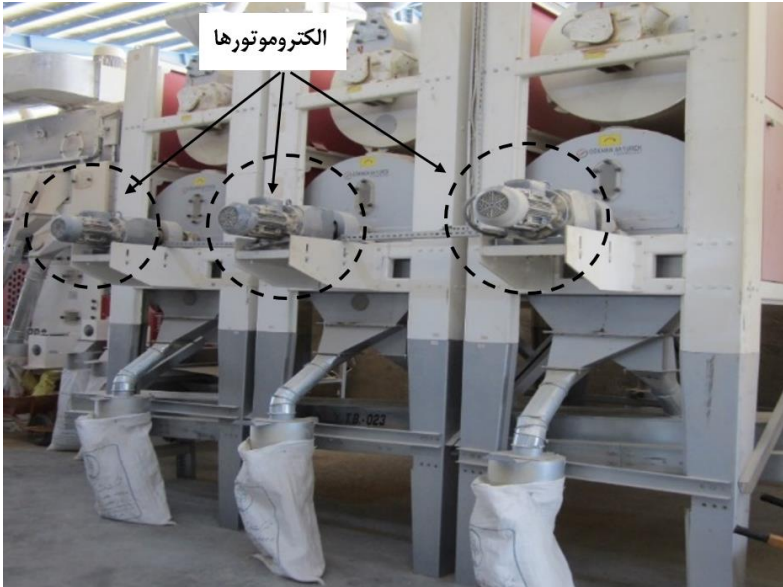
شکل ۳- الکتروموتورهای مورد استفاده در استوانه‌های جداساز
