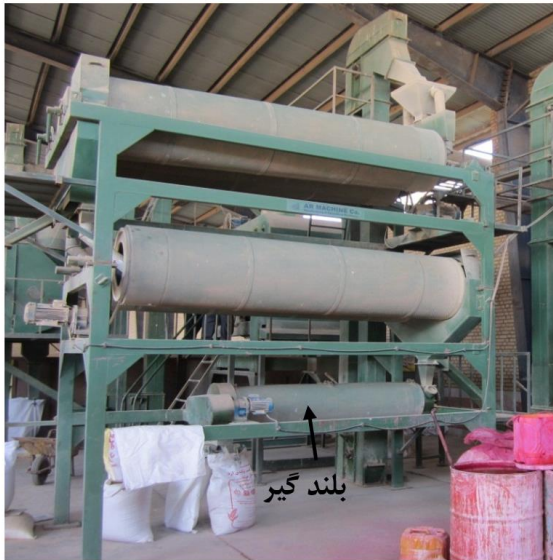
شکل ۱۴- استوانه بلندگیر مورد استفاده در زیر استوانه‌های خرده‌گیر و جوگیر
