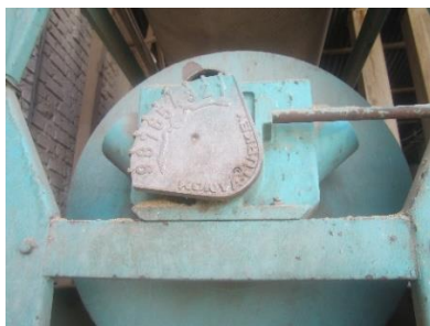
شکل ۸- اهرم چرخشی مخصوص تنظیم زاویه عرضی ناودانی استوانه‌های جداساز بذر
