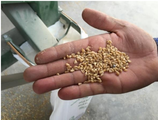
شکل ۱۶- خرده‌های گندم و سنگریزه در ضایعات ماشین خرده گیر
