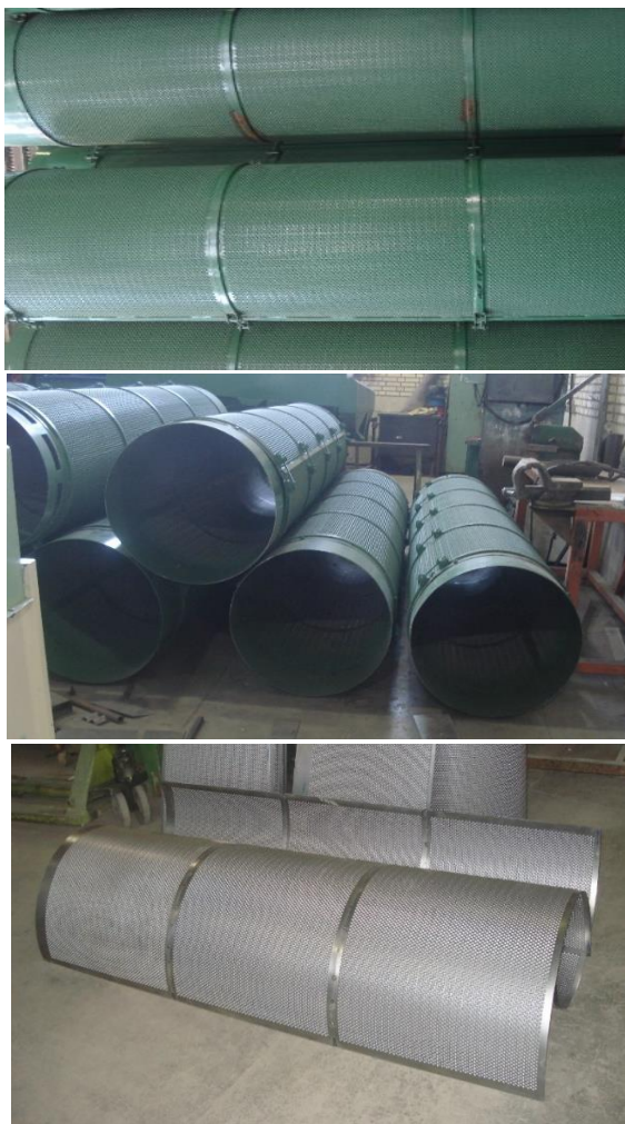
شکل ۴- دو نیم استوانه مورد استفاده در استوانه‌های جداساز بذر
