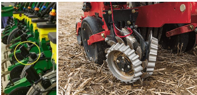
شکل ۱۷- استفاده از سامانه پایش و تنظیم الکترونیک فشار چرخ‌های مسدود کننده شیار کاشت بذر و پوشاننده بذر با زمان پاسخ کمتر از ثانیه
