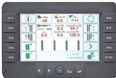
شکل ۱۵- کیت مدل ترا ۷ (TERA 7) ساخت شرکت گاسپاردو برای ایجاد ارتباط بین ماشین‌های ایزوباس با تراکتورهای غیر ایزوباس
