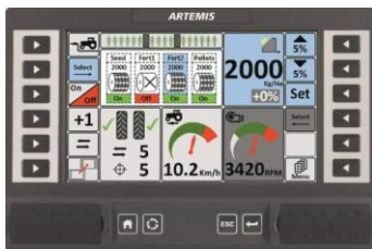
شکل ۲۸- کنسول یا جعبه کنترل کارنده عملکرد اجزای خطی کار
