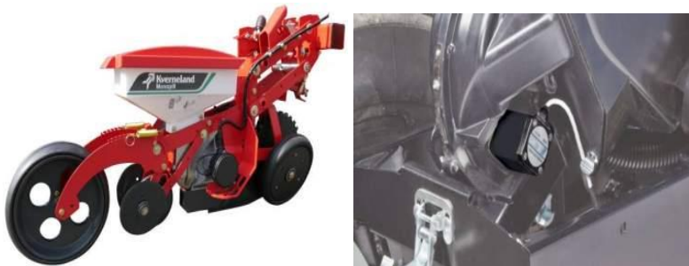
شکل ۱۱- استفاده از موتور الکتریکی برای چرخاندن صفحه بذر ردیف‌کار
