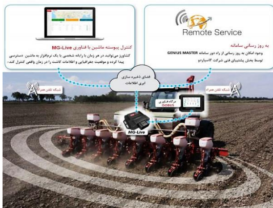
شکل ۱۴- شماتیک استفاده از فناوری‌های پیشرفته MG-Live، ISOBUS و شبکه تلفن همراه برای ارتباط با ماشین و کنترل الکترونیک عملکرد ردیف کار شرکت گاسپاردو.
