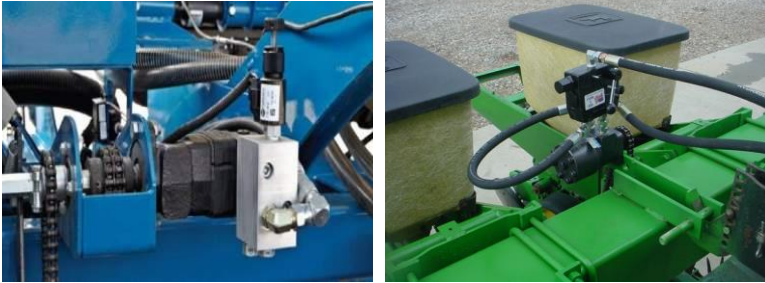
شکل ۸- استفاده از موتور (پمپ) هیدرولیکی برای چرخاندن صفحه موزع ردیف کار
