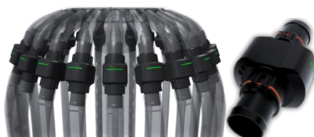
شکل ۲۵- حسگر نوری الکترونیکی برای تشخیص گرفتگی لوله سقوط و جریان بذر با سرعت حرکت بالا توسط باد (ویژه کارنده هوایی کمبینات)، مدل BlackEYE ساخته شرکت Digitroll مجارستان
