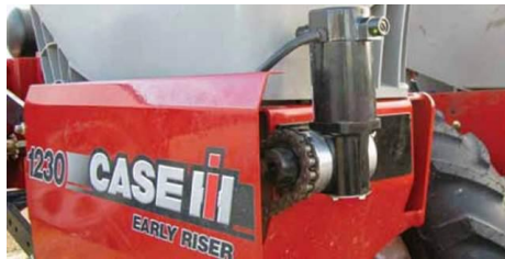
شکل ۲۷- استفاده از موتور الکتریکی برای چرخاندن محور موزع خطی کار
