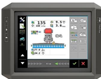
شکل ۱۶- کیت مدل تاچ ۸۰۰ ساخت شرکت گاسپاردو برای ایجاد ارتباط بین ماشین‌های ایزوباس با تراکتورهای غیر ایزوباس
