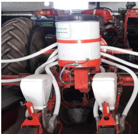
شکل ۱۹- نصب فناوری پاشش مواد محلول روی ردیف‌کار
