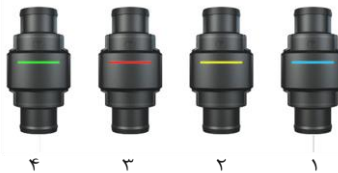
شکل ۲۳- علائم رنگی نشان دهنده وضعیت کاری حسگر بذر شرکت دیجیتزل: ۱-نیاز به‌روز رسانی، ۲-نیاز به تمیزکاری حسگر، ۳-گرفتگی یا قطع جریان بذر و ۴-عملکرد مطلوب
