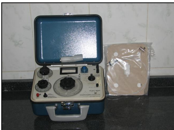
دستگاه پل شوری (Salinity bridge) جهت تعیین شوری خاک به صورت درجا در مزرعه
