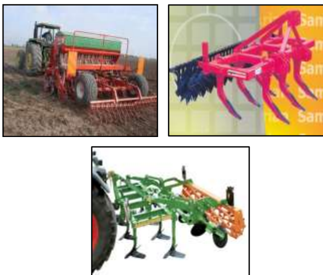
شکل ۶- نمونه ای از ادوات کم خاک‌ورزی (خاک ورز مرکب-راست و چیزل پکر-وسط) و ادوات بی خاک‌ورزی (ماشین کاشت مستقیم -چپ)
