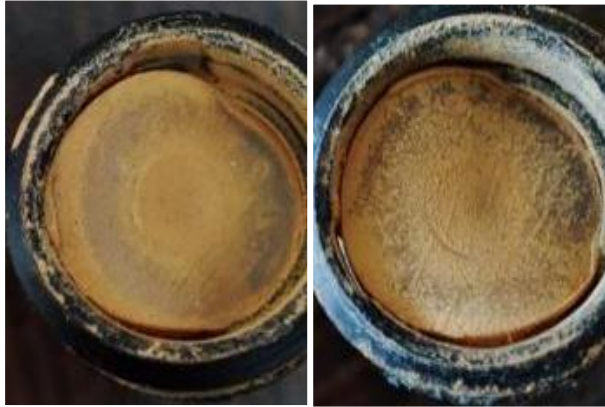
شکل ۵- تصویری از چسبیدگی دیافراگم در قطره‌چکان‌های نتافیم ۸ لیتر در ساعت
