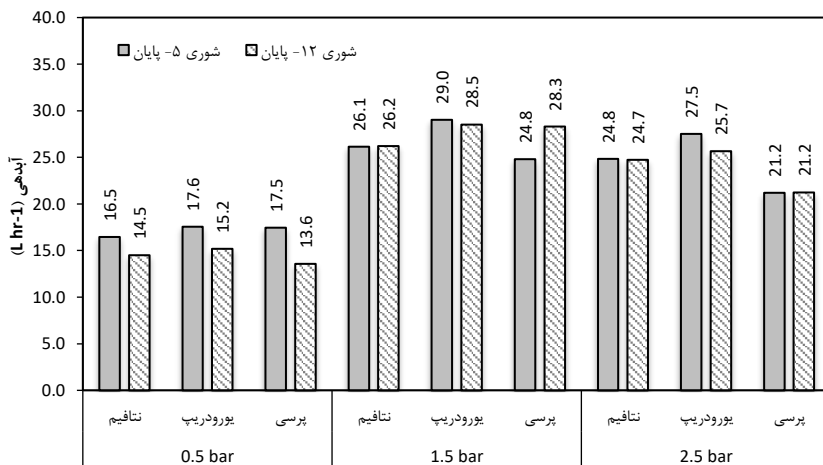
شکل ۹- میانگین آبدهی در قطره‌چکان‌های مختلف (بالا: ۸ لیتر در ساعت و پایین: ۲۴ لیتر در ساعت) تحت فشارها و شوری‌های مختلف پس از پایان آزمایش‌ها
