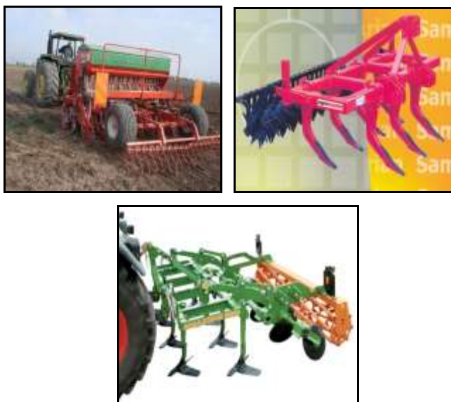
شکل ۶- نمونه ای از ادوات کم خاک‌ورزی (خاک ورز مرکب-راست و چیزل پکر-وسط) و ادوات بی خاک‌ورزی (ماشین کاشت مستقیم -چپ)
