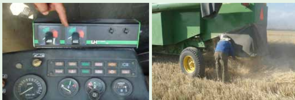
شکل ۹. راست: اندازه‌گیری افت کمباین، چپ: نمایشگر افت کمباینی غلات
