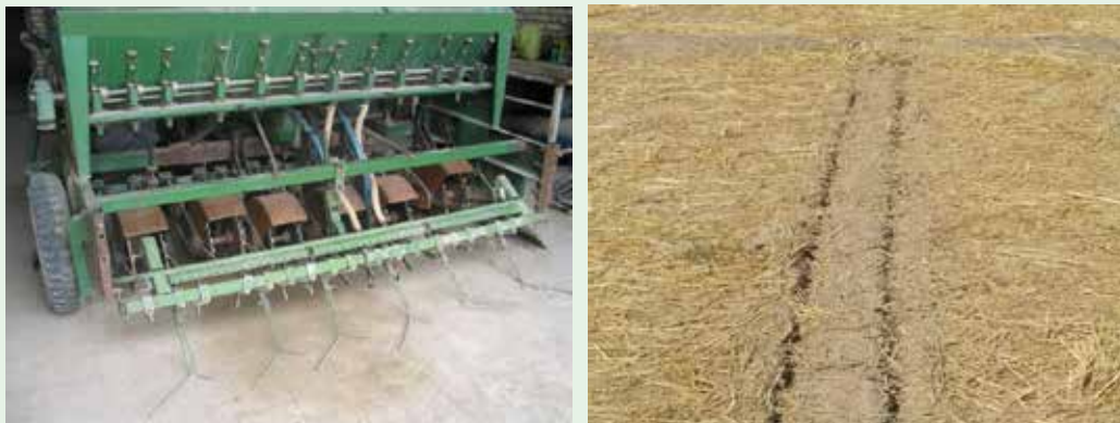
شکل ۱۵. راست: شیار ایجاد شده توسط شیار باز کن دو تایی، چپ: دستگاه کاشت با شیار باز کن فعال برای کاشت گندم
