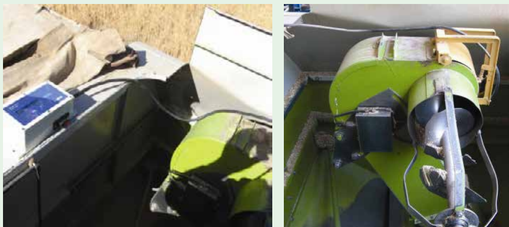
شکل ۳۶. سامانه پهنه بندی عملکرد زمین زراعی قابل نصب بر روی کمباین
