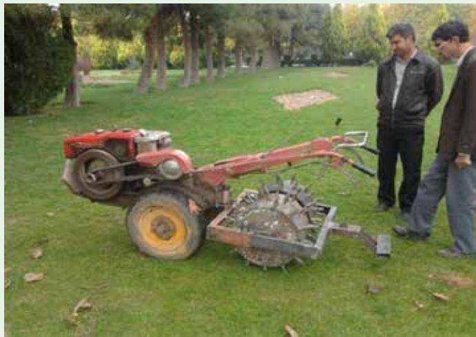
شکل ۳۳. دستگاه هواده ساخته شده متصل به تراکتور دو چرخ
