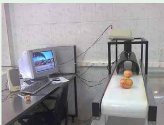
شکل ۳۷. سامانه‌های آکوستیکی تشخیص و درجه‌بندی غیر مخرب محصولات کشاورزی
