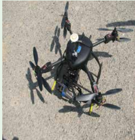
شکل ۳۶. سامانه عمود پرواز بدون سرنشین برای سنجش از دور هوایی
