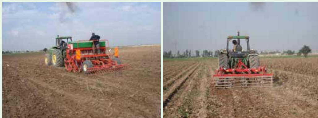
شکل ۱. عملیات کم خاک‌ورزی با خاک ورز مرکب (راست) و عملیات بی خاک‌ورزی با بذرکار خطی کار کاشت مستقیم (چپ) - دزفول
