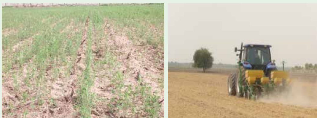
شکل ۲. عملیات بی خاک‌ورزی با بذرکار ردیف‌کار کاشت مستقیم (راست) و کاشت مستقیم یونجه در بقایای ذرت (چپ) - دزفول
