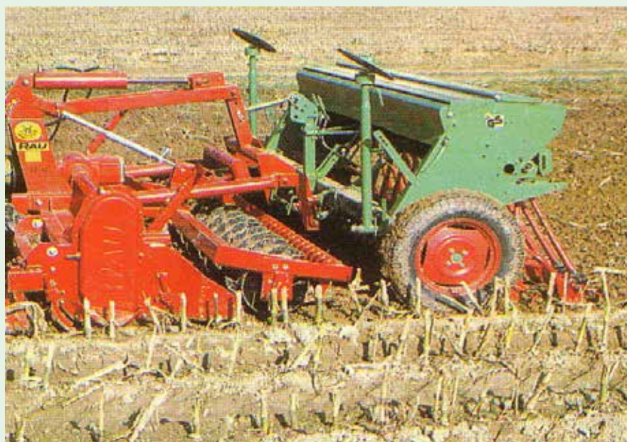
شکل ۸. کاربرد کمبینات در مزرعه دارای بقایای گیاهی
