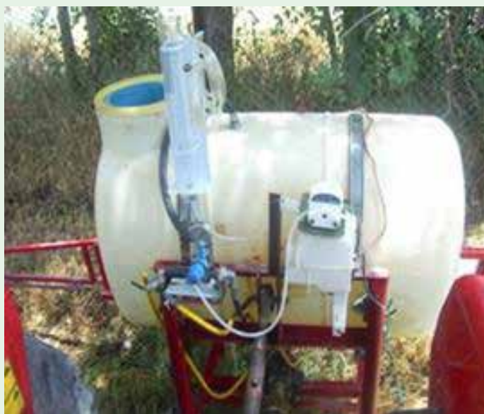
شکل ۱۹. سمپاش غلظت متغیر انژکتوری
