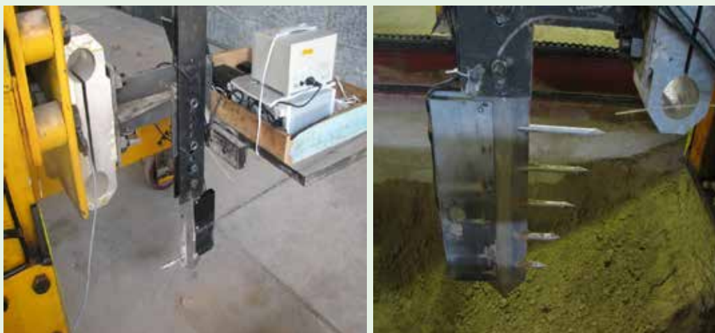
شکل ۳۵. حسگر اندازه‌گیری مقاومت مکانیکی خاک به‌طور پیوسته (راست) و حسگر افقی برای اندازه‌گیری پیوسته رطوبت خاک (چپ)
