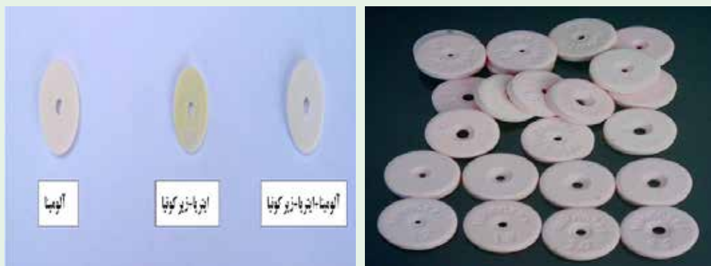
شکل ۴۰. نمونه‌ها در سه جنس مختلف: نمونه مرسوم: آلومینا، نمونه نانو کامپوزیت: آلومینا+ زیرکونیا+ ایتریا، نمونه نانومواد: ایتریا+
