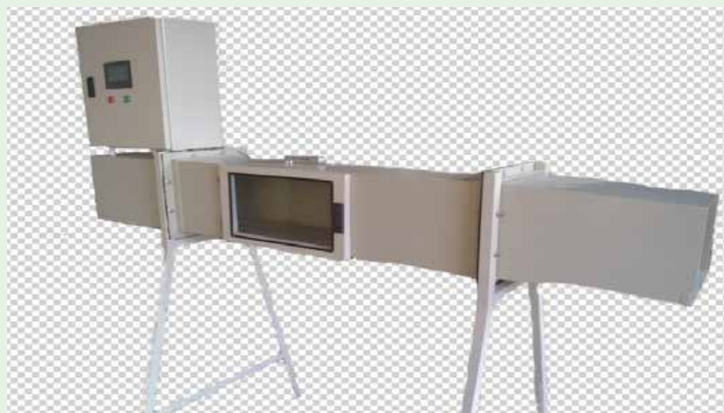
شکل ۲۷. خشک کن آزمایشگاهی مجهز به PLC
