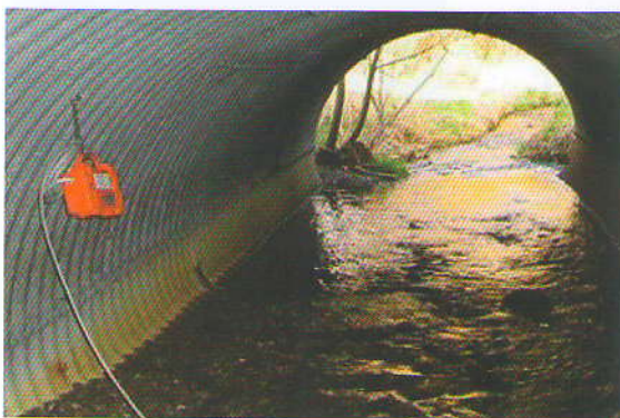
شکل ۱۲- نحوه نصب و استفاده از سرعت سنج اولتراسونیک
