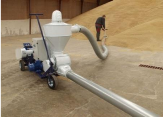
شکل ۳- انتقال نیوماتیکی غلات به مخازن ذخیره سازی در فاصله های مشخص
