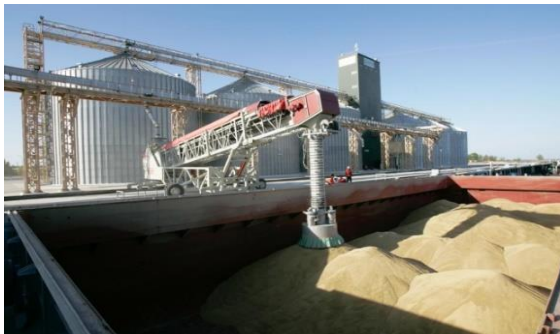
شکل ۱- تخلیه مکانیکی و نیوماتیکی محموله گندم از سیلو به کشتی
