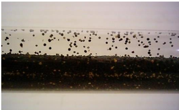
شکل ۷- انتقال دانه کلزا در حالت فاز غلیظ
