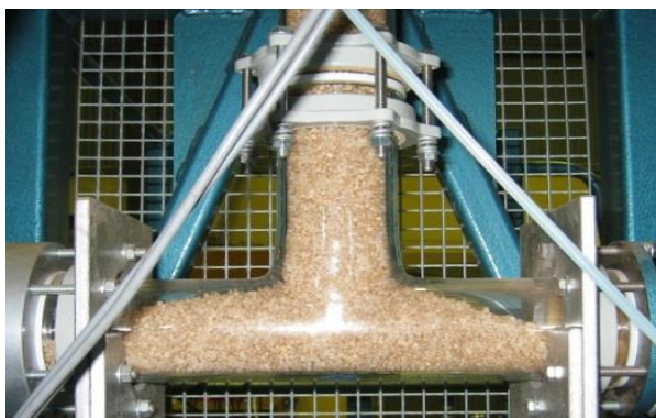
شکل ۴- وضعیت جریان‌پذیری مواد در مسیر انتقال نیوماتیکی
