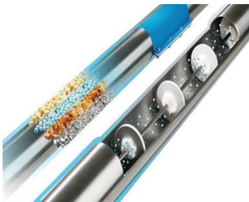
شکل ۱۷: سیال‌سازی مواد در سیستم‌های انتقال هوایی-مکانیکی توسط جریان پرسرعت هوا
