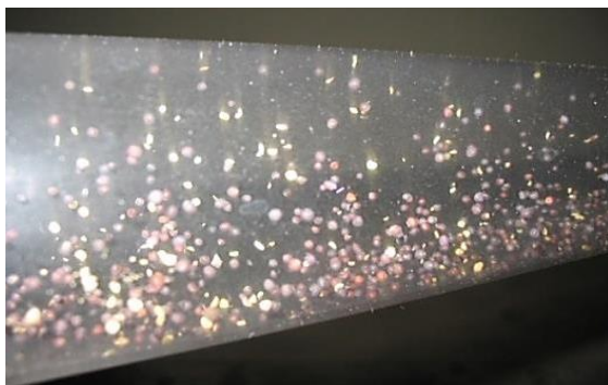
شکل ۶- انتقال دانه کلزا در حالت فاز رقیق
