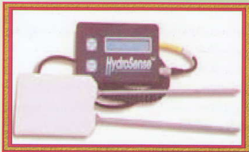
شکل (۱۰): یکی از انواع رطوبت سنج خاک TDR
