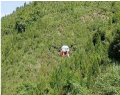
شکل ۹- سمپاشی باغ های شیب دار و متراکم با پهپاد
