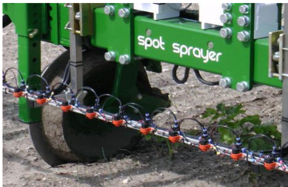
شکل ۴- سمپاش بسیار کم حجم، برای ایجاد قطره‌های بسیار کوچک و کاربرد محلول سم در حجم کمتر از ۵ لیتر در هکتار
