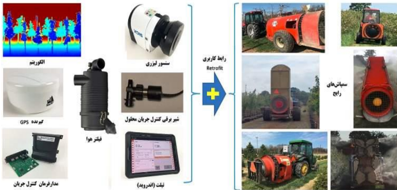
شکل ۱۷- اجزای سامانه کنترل اتوماتیک و هوشمند پاشش با قابلیت متصل شدن به سمپاش‌های موجود، ارائه شده توسط سرویس تحقیقات کشاورزی آژانس تحقیقات داخلی وزارت کشاورزی امریکا.
