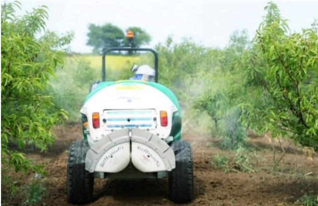
شکل ۱۳- نازل و سمپاش الکترواستاتیک پشت تراکتوری برای سمپاشی باغ (منبع: شرکت بادله)
