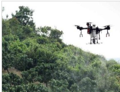
شکل ۹- سمپاشی باغ های شیب دار و متراکم با پهپاد
