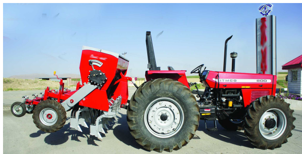
شکل ۹- خطی کارهای کاشت مستقیم غلات دارای شیار بازکن های T یا وارونه
