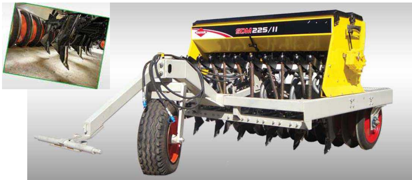
شکل ۸- عمیق کار ساخت یکی از شرکت های داخلی مجهز به شیاربازکن بیلچه ای
