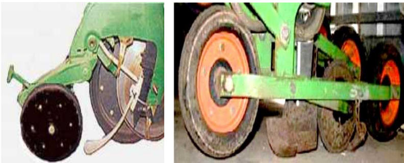
شکل ۱۵- چرخ فشارنده بذر به دنبال شیاربازکن کفشکی (راست)، فشارنده لغزشی بذر به دنبال شیاربازکن دودیسی
