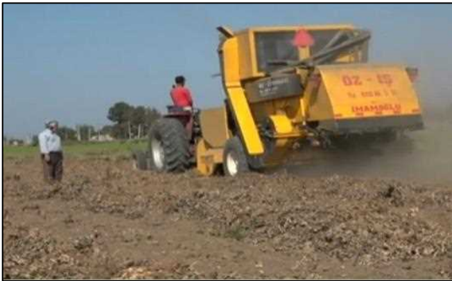
شکل ۱۹- کمباین مزرعه‌ای برای جدا کردن میوه بادام زمینی
