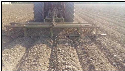
شکل ۲- استفاده از شیپر در تهیه بستر بذر بادام زمینی
