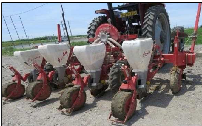
شکل ۱۲- پوشاننده بیلچه‌ای و چرخ فشار مورد استفاده در کاشت بادام‌زمینی
