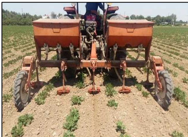
شکل ۱۵- کودهی و فاروگشی مجدد مزرعه بادام زمینی در مغان
