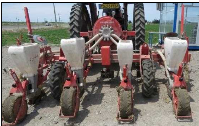
شکل ۳- بذرکار پنوماتیک برای کاشت بادام زمینی
