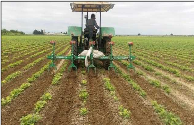
شکل ۱۴- استفاده از کولتیواتور شمشیری در مزرعه بادام زمینی مغان
