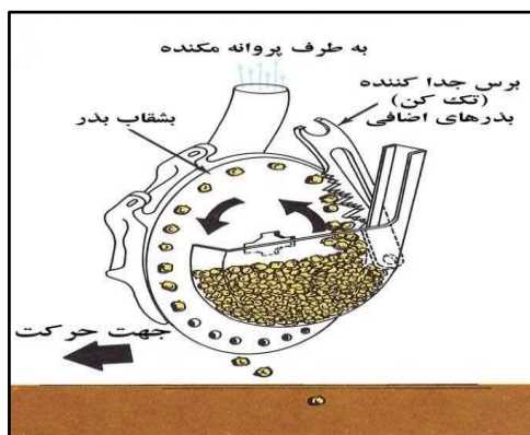
شکل ۱۰- موزع صفحه‌ای تحت مکش در ردیف کار پنوماتیکی برای کاشت بادام زمینی
