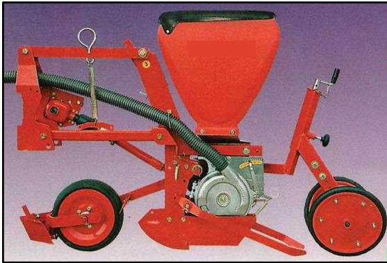
شکل ۷- شیار بازکن مورد استفاده برای کاشت بادام زمینی در مغان
