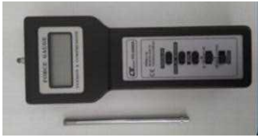
شکل ۳- نفوذسنج دیجیتالی پرتابل به همراه پروب
