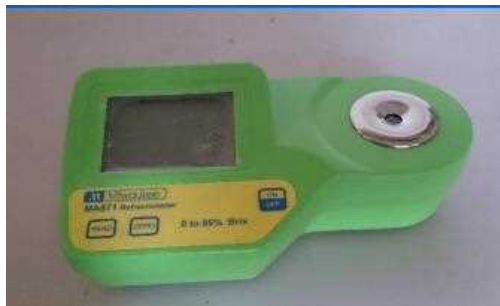
شکل ۲- رفاکتومتر دیجیتالی پرتابل برای اندازه‌گیری TSS
