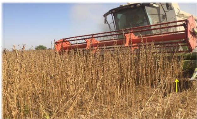
شکل ۳۶. برش بوته‌ها از زیر اولین کپسول (پیکان زرد رنگ). عکس از شرکت کشت و صنعت شهید رجایی، دزفول، سال ۱۴۰۲.
