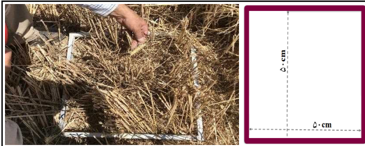
شکل ۵- انداختن کادر فلزی چهار طرفه با ابعاد داخلی ۵۰ در ۵۰ سانتی‌متر، برای تعیین تلفات پلتفرم
