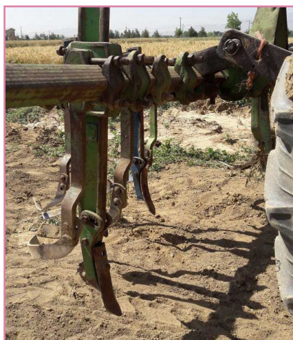
شکل ۱۰- عملیات خاک ورزی بین ردیفی با کولتیواتور تیغه شمشیری مجهز به بازو و تیغه‌های قلمی
