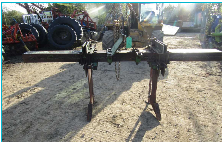
شکل ۳- برای از بین بردن سخت لایه در عمق توسعه ریشه چغندر قند لازم است از زیرشکن استفاده کرد.
