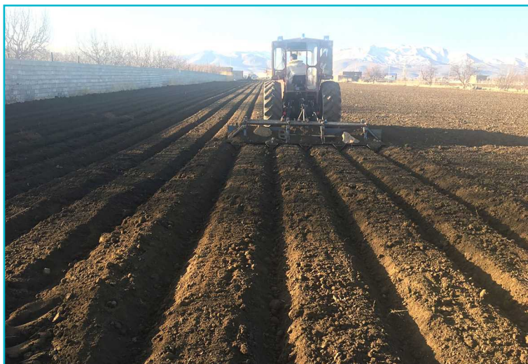
شکل ۸- ایجاد ردیف‌های کاشت با دستگاه بسترساز برای زراعت چغندر قند در شکل دهی بستر کاشت و ایجاد شرایط مناسب به منظور کاشت بذرو جوانه زنی آن مؤثر است.
