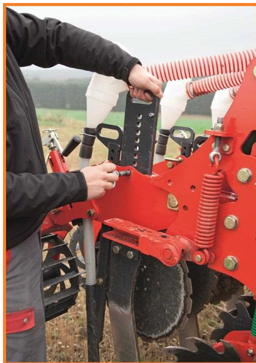
شکل ۶۸ - تنظیم ساق زیرشکن با حرکت در جهت عمودی
