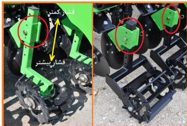
شکل ۷۰- تنظیم جابجایی شاسی غلتک روی شاسی ماشین
