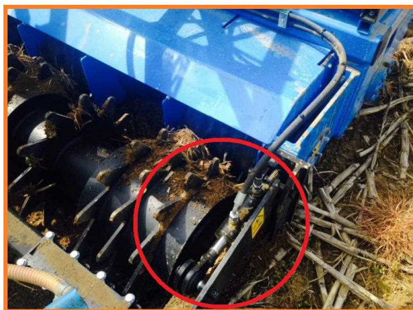
شکل ۹۰- تنظیم ارتفاع غلتک دندان‌دار با استفاده از جک هیدرولیکی
