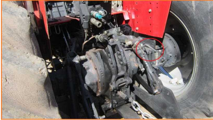
شکل ۵۹- تغییر طول بازوی رابط سمت راست تراکتور برای تنظیم تراز عرضی
