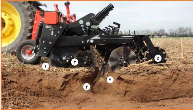
شکل ۱۲- عمق کار اجزای مختلف خاک‌ورز نواری غیرفعال (۱- پیش‌بر بشقابی ۲- ردیف ساز بشقابی ۳- ساق زیرشکن ۴- خردکن بشقابی ۵- کلوخ خردکن و تثبیت‌کننده)
