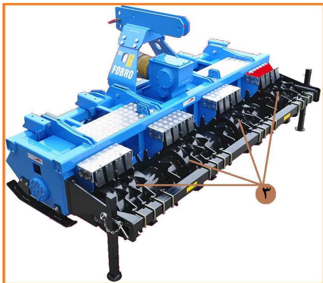
شکل ۱۰- ماشین خاک‌ورز نواری فعال (از عقب) (۳-غلتک با زائده کاردی)
