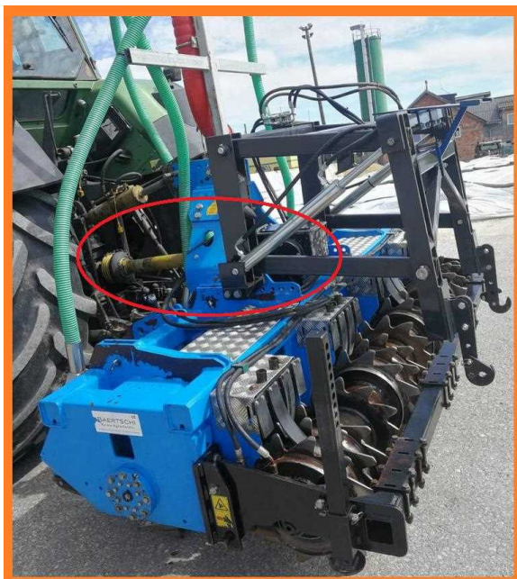
شکل ۷۷- انتقال قدرت از محور تواندهی تراکتور به محور
