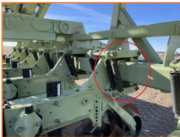
شکل ۶۱- روش استفاده از قاب متوازی‌الاضلاع برای کنترل عمق اختصاصی شیار بازکن
