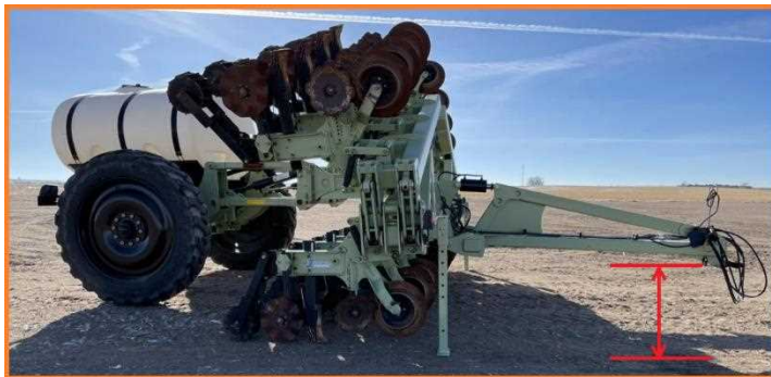
شکل ۴۳- تنظیم ارتفاع مالبند ماشین
