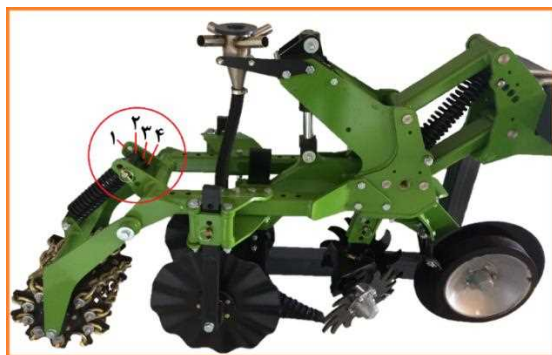
شکل ۷۱- تنظیم فشار فنر غلتک خاک کوب
