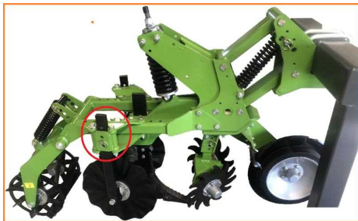
شکل ۶۹- تنظیم ارتفاع بشقاب‌ها
