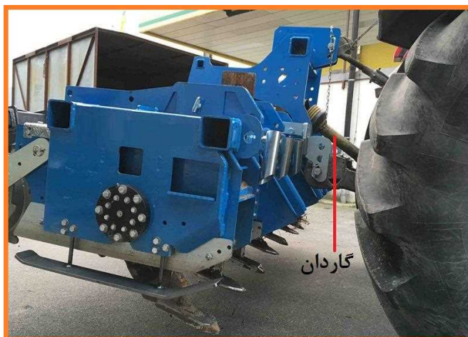
شکل ۱۱- انتقال قدرت دورانی از محور توان‌دهی تراکتور
