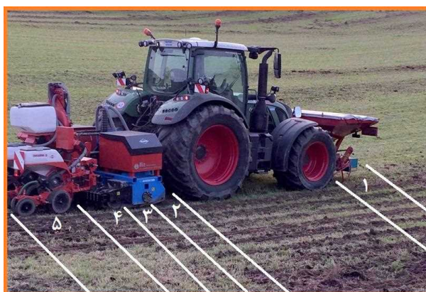
شکل ۷۹- ماشین مرکب با ترکیب ماشین کودپاشی، خاک‌ورز نواری فعال و ماشین کاشت
