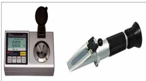
شکل ۲-۴- رفراکتور متر دستی برای اندازه‌گیری مواد جامد انحلال‌پذیر سیب (فائو، ۲۰۱۸)
