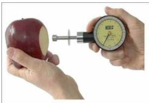
شکل ۲-۵ - پنترومتر دستی میوه (فائو، ۲۰۱۸)
