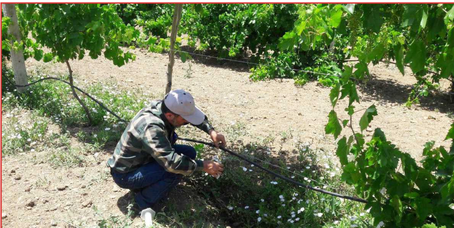
شکل ۴- اندازه‌گیری دبی قطره‌چکان‌ها در آبیاری قطره‌ای
