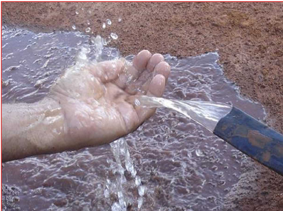
شکل ۱۱- کنترل فیزیکی آب در انتهای لاترال
