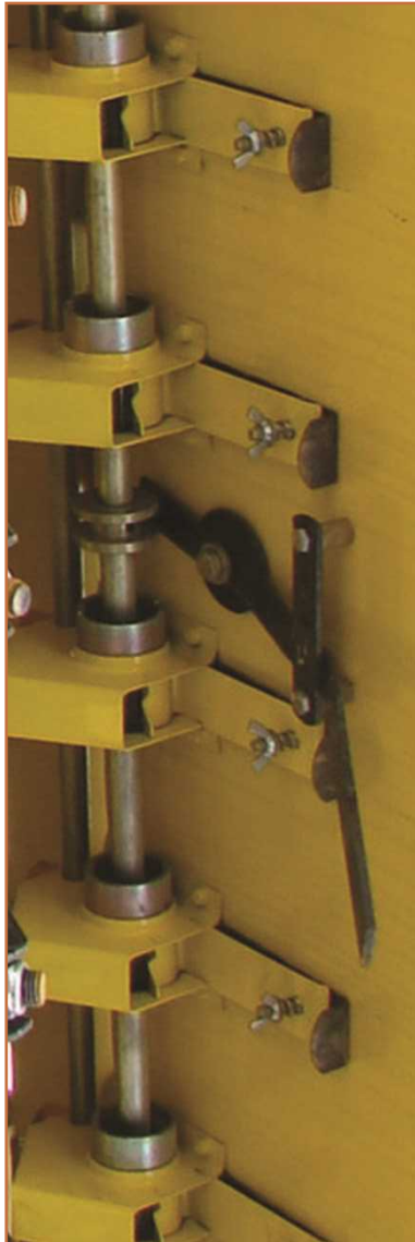
شکل ۸۰- تنظیم طول شیار موزع
