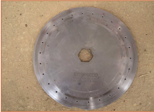
شکل ۲۳- صفحه بذر در ردیف کارهای پنوتیکی
