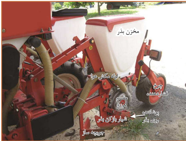
شکل ۳- قسمت های مختلف یک کارنده
