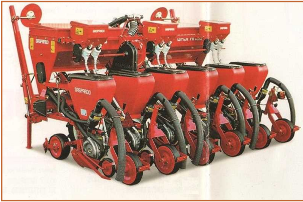
شکل ۹- ردیفکار شش ردیفه پنوماتیکی
