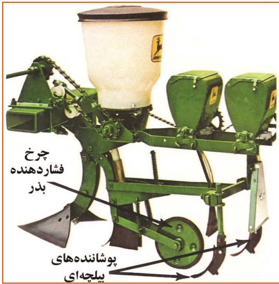
شکل ۳۳- پوشاننده بیلچه‌ای و چرخ فشاردهنده بذر
