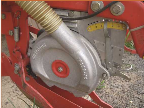
شکل ۲۱- دستگاه اندازه‌گیری (سنجش) بذر (مقسم یا موزع)
