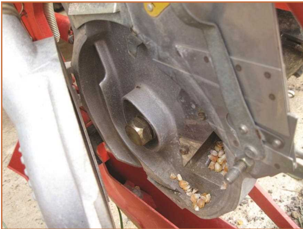
شکل ۲۲- قسمت های داخلی یک موزع پنوماتیکی
