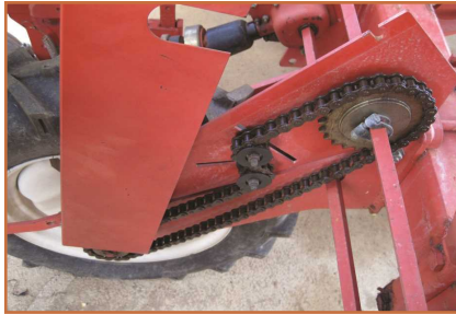
شکل ۱۳- سیستم انتقال نیرو از چرخ زمینی در یک نوع ردیف کار
