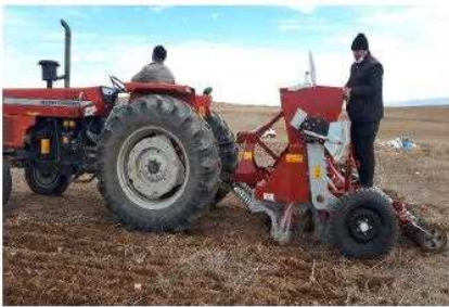
شکل ۱- تصویر سمت راست ماشین کشت بی خاکورزی و تصویر سمت چپ ماشین کشت حفاظتی (کم خاکورزی)
