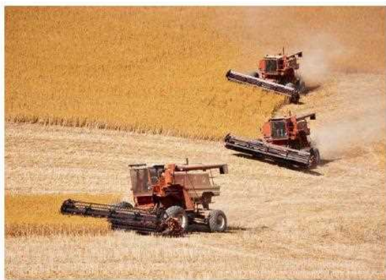
شکل ۷- برداشت غوزه (دانه) گلرنگ توسط کمباین غلات
