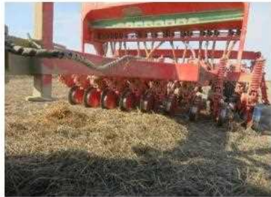
شکل ۱- تصویر سمت راست ماشین کشت بی خاکورزی و تصویر سمت چپ ماشین کشت حفاظتی (کم خاکورزی)
