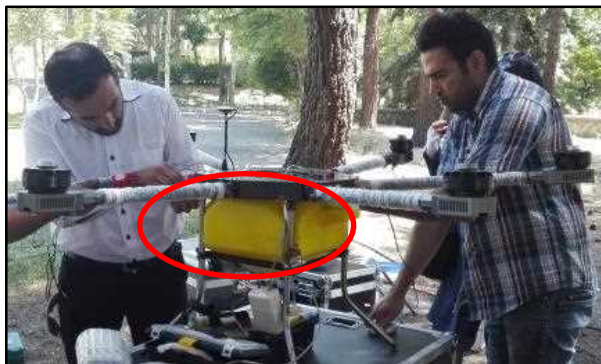
شکل ۱۶- مخزن سم در پهپادسمپاش
