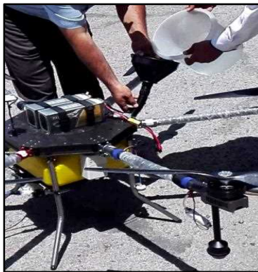
شکل ۱۸- واسنجی بده خروجی پهپادسمپاش
