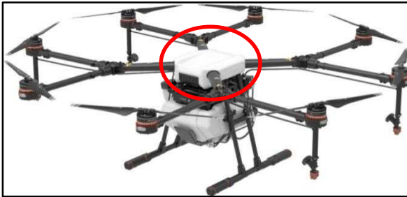
شکل ۸- واحد خنک کننده داخلی پهپادسمپاش
