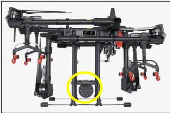
شکل ۱۱- حسگر راداری نصب شده زیر پهپادسمپاش
