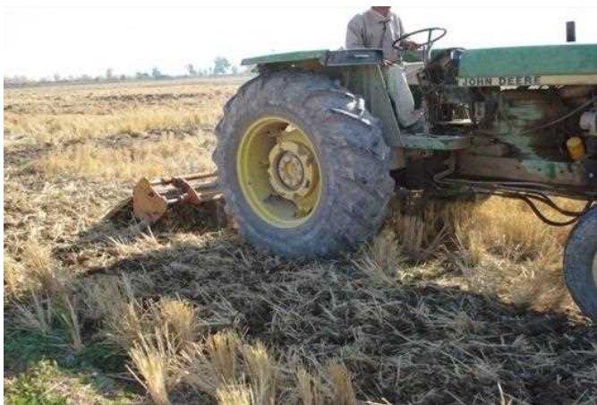
شکل ۷- عملیات کم خاک ورزی حفاظتی در بقایای برنج با استفاده از رتیواتور
