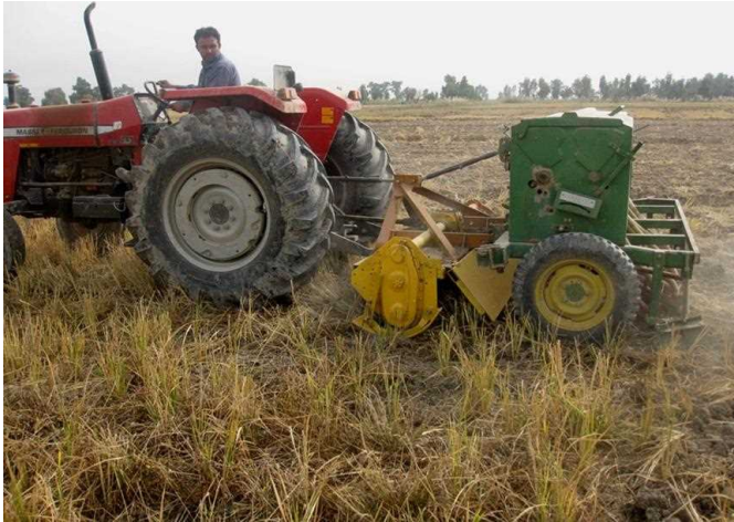
شکل ۸- استفاده از ماشین مرکب خاک‌ورز-کاشت نوری
