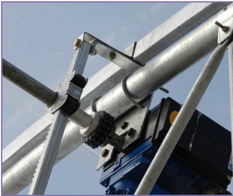
شکل ۱۹- سیستم برقی باز و بسته کردن دریچه سقفی
