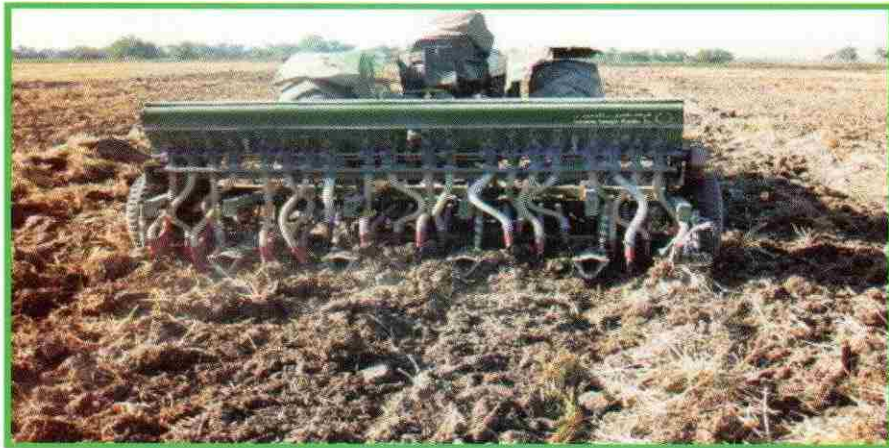
شکل ۱۴ - خطی کار در حال کاشت بذر گندم و کود در یک زمین تهیه شده با گاواهن و دیسک
