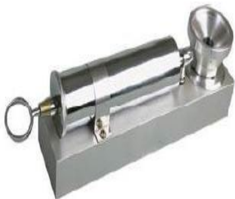
دستگاه رسوب گیر با استفاده از کاغذ فیلتر (Fikter Patch)
