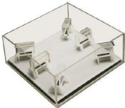
دستگاه رسوب گیر با استفاده از شیشه لام
