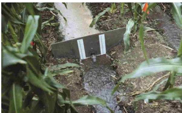
شکل ۵۰- نمایی از روزنه دایره‌ای نصب شده در مزرعه که یصورت آزاد کار می‌کند.
