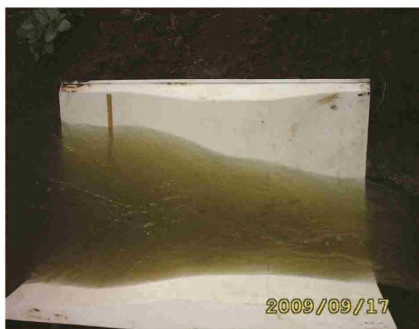
شکل ۶۳- نمایی از پارشال های ذوزنقه ای
