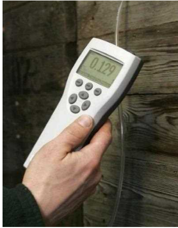
شکل ۳۲- دستگاه سنجش دی اکسیدکربن قابل حمل منبع: ( https://potatoes.news )
