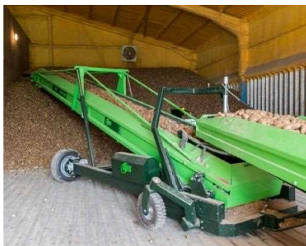
شکل ۱۵- استفاده از نوار نقاله سیار برای کاهش آسیب و تسریع در جابه‌جایی توده سیبزمینی منبع: ( https://www.agriexpo.online )
