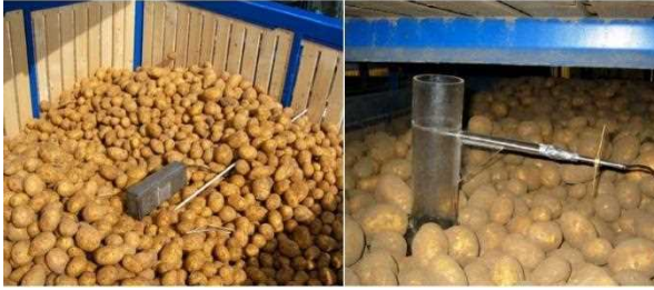
شکل ۱۴- نحوه صحیح قرارگیری حسگر دما در سطح توده سیب‌زمینی انبار شده. منبع: (پربنگل و همکاران، ۲۰۰۹)
