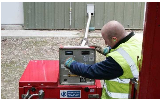
شکل ۳۴- تزریق گاز گرم کلروپروفام به انبار سیب‌زمینی
