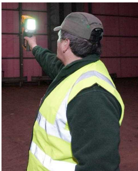
شکل ۳۰- استفاده از دوربین حرارتی برای شناسایی درز و شکاف موجود در سطوح عایق شده
