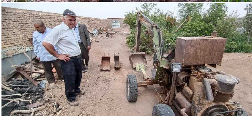
تصویر ۱۳- ماشین حفر ترانشه در باغ (ابداعی کشاورز پیشرو)
