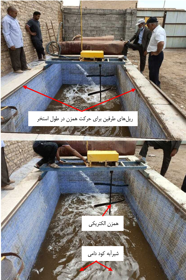
ادامه تصویر ۱۴- استخر فرآوری برای تهیه شیرابه از کود دامی (ابداعی کشاورز پیشرو)
