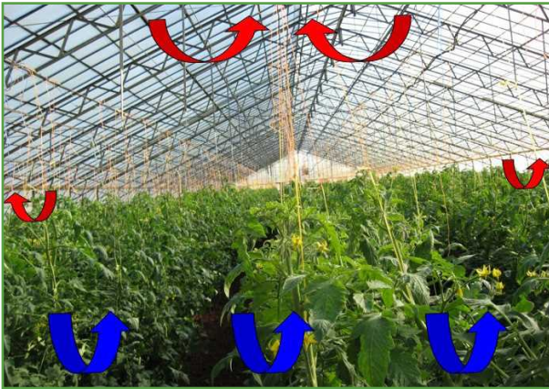
شکل ۷- تلفات حرارتی ناشی از نشت هوا به داخل یا خارج گلخانه
