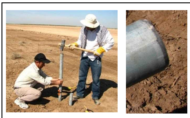
شکل ۲- روش نمونه‌برداری از خاک سطحی با استفاده از لوله فولادی لبه‌تیز
