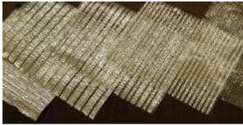
شکل ۱۹- پرده‌های نیمه‌متخلخل با درصد‌های مختلف عبور نور (از چپ به راست: ۰، ۲۵، ۳۵، ۴۵ و ۸۵ درصد)
