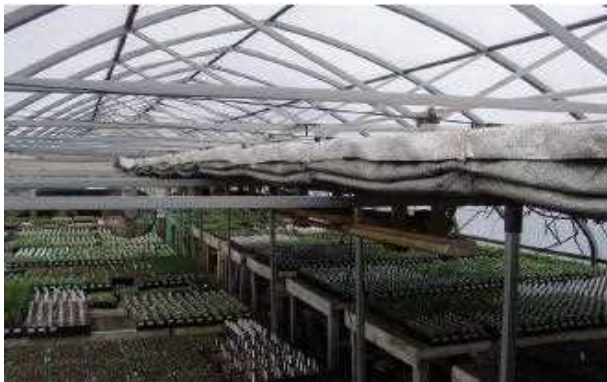
شکل ۱۰- نحوه تا شدن پرده آویزان، هنگام باز شدن آن
