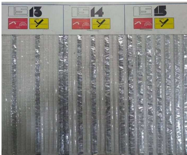
شکل ۲۰- پرده‌های ذخیره انرژی با تراکم‌های مختلف نوارهای آلومینیمی به ترتیب از چپ به راست با ۵۰، ۵۰ و ۵۵ درصد ذخیره انرژی و ۳۰، ۴۰ و ۵۰ درصد سایه‌اندازی
