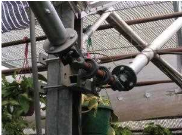
شکل ۱۳- استفاده از یک چهار شاخ گاردان ۱ برای انتقال قدرت از یک دهانه به دهانه دیگر در سیستم محرک کابلی
