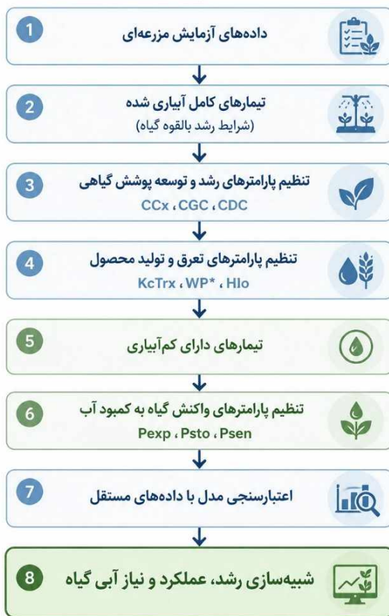
شکل ۸۸- مراحل روش کالیبره کردن مدل AquaCrop بر اساس روش پیشنهادی Paredes et al. , 2014 و Jahandideh et al. , 2026
