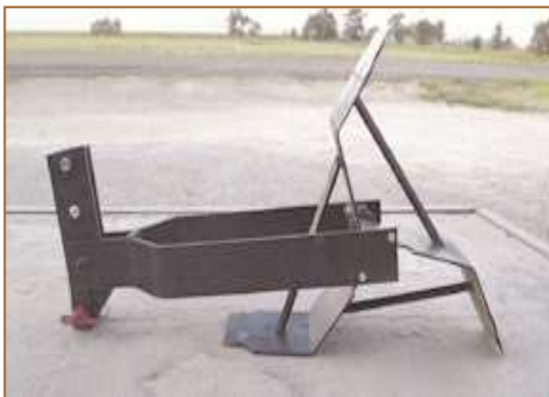
شکل ۱۴- یک واحد از شیپار بند پارویی و اجزای آن
