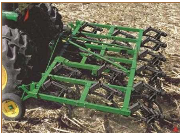
شکل ۸۱- حفظ بقایای گیاهی در سطح خاک در هنگام شخم با گاوآهن چیزل
