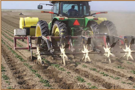
شکل ۳۳- ماشین خاک‌ورز مخزنی مجهز به جک هیدرولیکی
