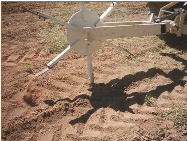
شکل ۳۲- خاک‌ورز مخزنی مجهز به فنر شناوری
