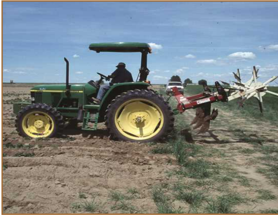
شکل ۲۲- افزودن ماشین خاک‌ورز مخزنی به خاک‌ورز اصلی
