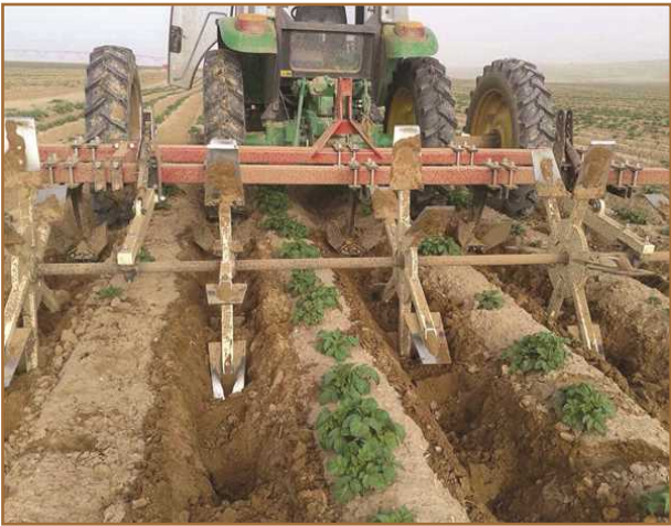
شکل ۳۰- خاک‌ورز مخزنی با چرخ‌های عنکبوتی سوار شده روی یک محور
