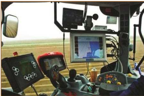
شکل ۶۳- انواع پایشرهای سامانه‌های اطلاعات جغرافیایی و جی‌پی‌اس مخصوص تراکتورها و ماشین‌های کشاورزی
