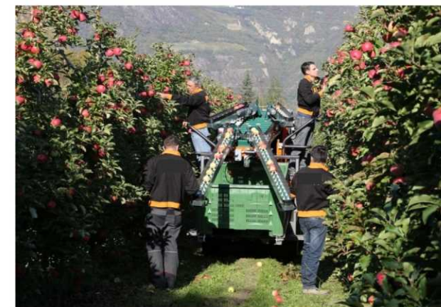
شکل ۱۰- ماشین نیمه مکانیزه خودگردان دارای نقاله مخصوص انتقال میوه به جعبه
