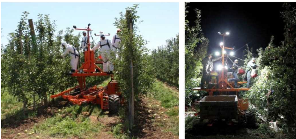
شکل ۱۲- ماشین نیمه مکانیزه برداشت دارای کمربند ایمنی خدمه ماشین و نورپردازی برای کار در شب
