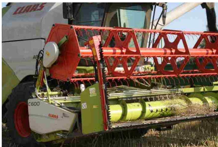
شکل ۸۴- هلیس (ماریچ دو طرفه)
