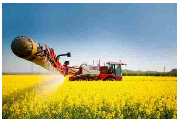
شکل ۷۰- سمپاش بوم‌دار هواکمک
