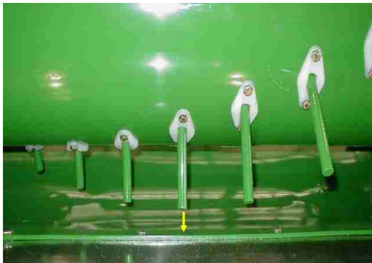
شکل ۱۱۰- فاصله انگشتی‌ها تا کف سکو
