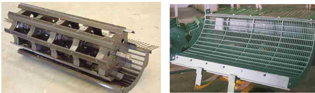
شکل ۸۹- کوبنده و ضد کوبنده سوهانی
