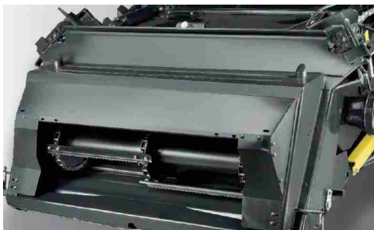
شکل ۸۷- استوانه تغذیه و زنجیر نقاله
