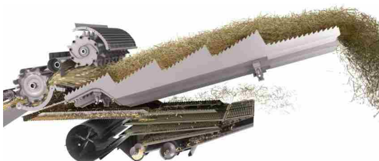
شکل ۹۶- جریان انتقال مواد از کاه‌برها به سینی دانه
