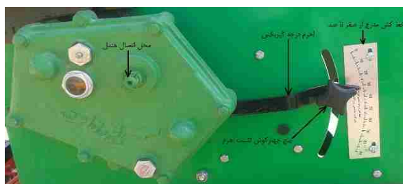
شکل ۶۵- محل قرارگیری هندل و تنظیم اهرم درجهٔ گیربکس
