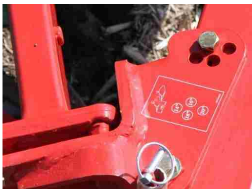
شکل ۲۸- تغییر زاویه هر خیش
