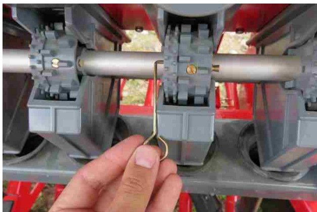
شکل ۵۳- موزع غلتکی دندانه‌دار
