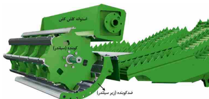
شکل ۹۰- استوانه کلش کش
