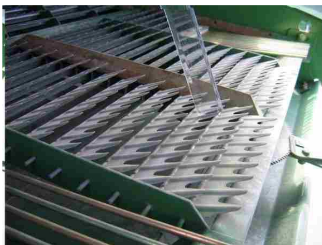
شکل ۱۱۳- نحوه اندازه‌گیری روزنه الک
