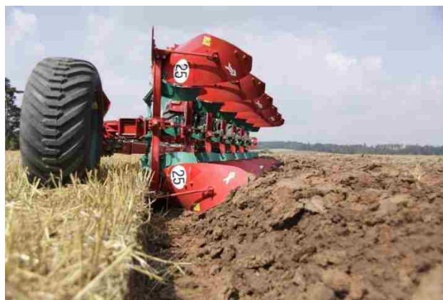
شکل ۲۳- دید از پشت برای تشخیص تراز عرضی
