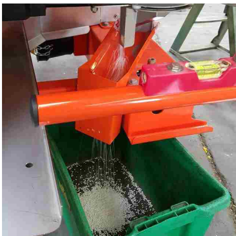
شکل ۴۴- قرار دادن ظرف زیر خروجی مخزن
