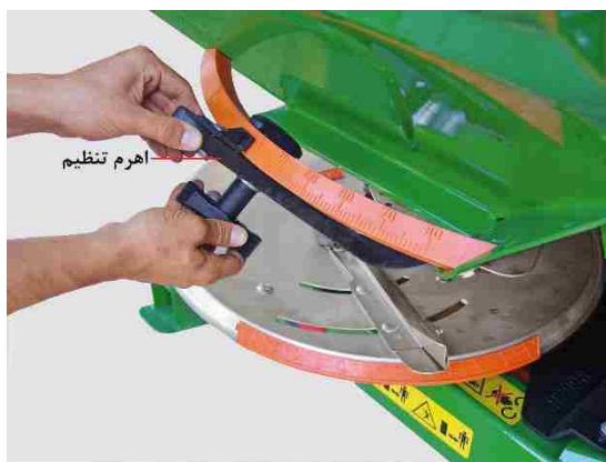
شکل ۴۳- تنظیم دریچه خروجی کود از مخزن
