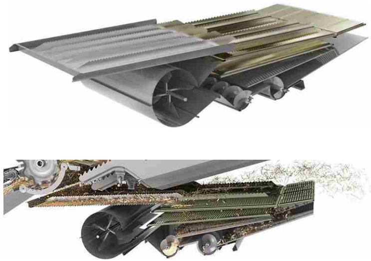
شکل ۱۰۰- سینی دانه، الک بالایی، الک پایینی، دنباله الک بالایی و بادبزن
