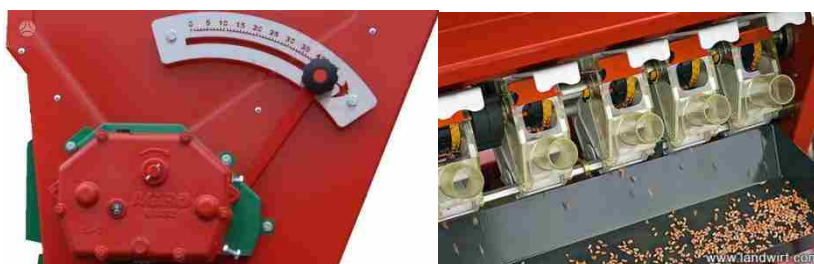
شکل ۵۴- تغییر سرعت چرخش موزع آجدار
