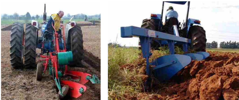
شکل ۱۹- شخم با گاوآهن یکطرفه
