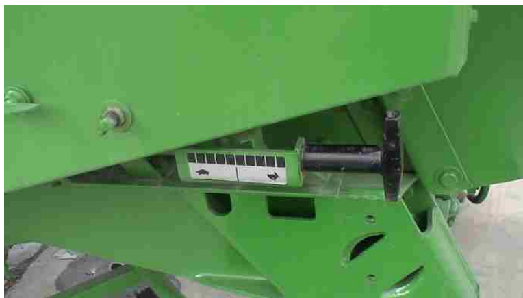
شکل ۱۱۲- دستگیره تنظیم سرعت باد پنکه
