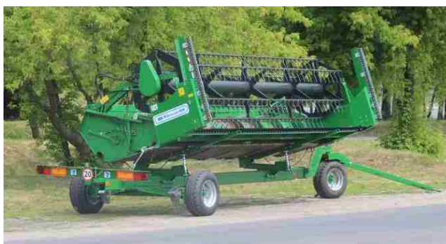
شکل ۷۹- واحد درو (پلاتفرم) کمباین کلزا
