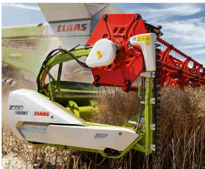
شکل ۸۱- برش عمودی شانه برش عمودی
