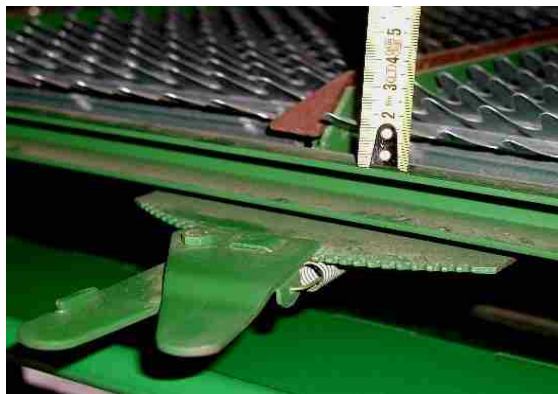
شکل ۱۰۲ - تنظیم سوراخ‌های الک بالایی
