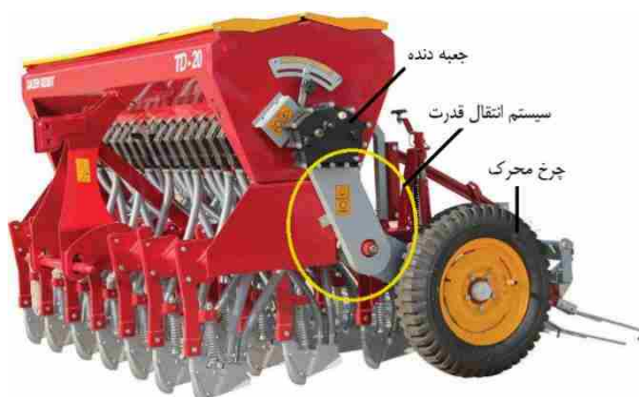
شکل ۴۹- نمای کلی انتقال قدرت از چرخ محرک به محور موزع
