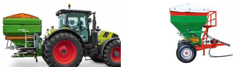
شکل ۳۹- کودپاش کششی (چپ) و سوارشونده (راست)
