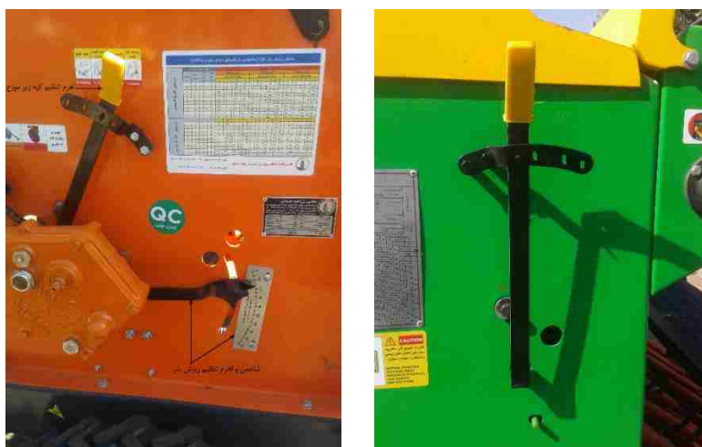
شکل ۶۲- اهرم تنظیم کپه زیر موزع
