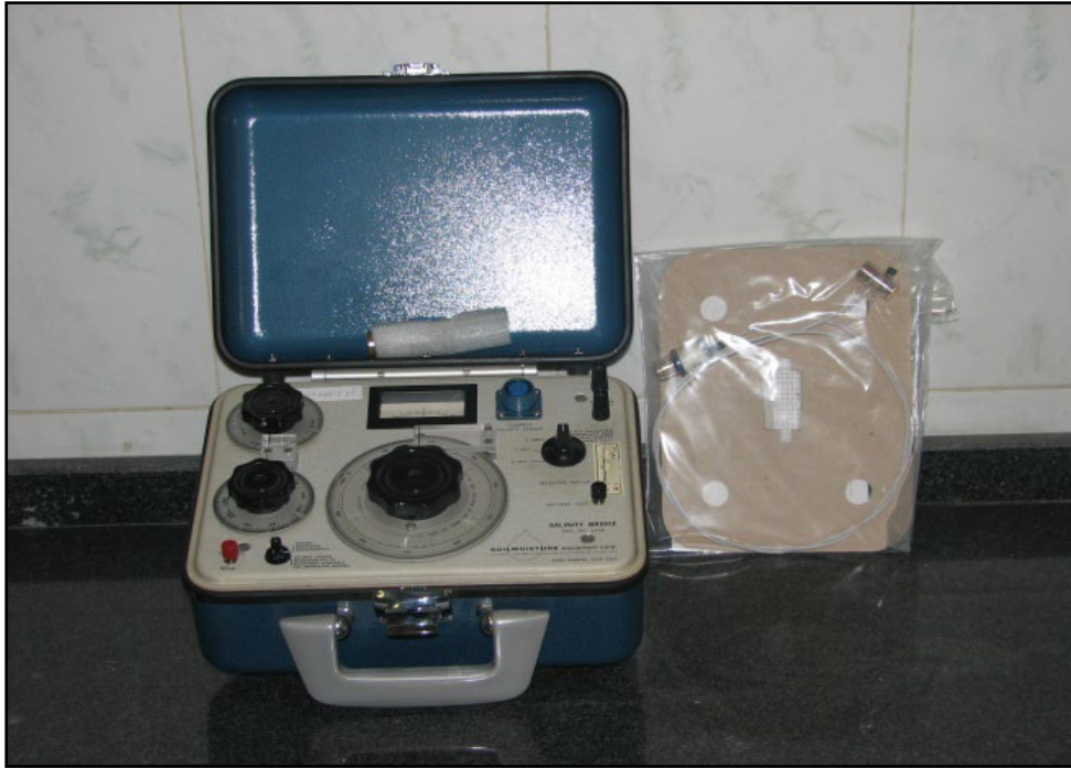
دستگاه پل شوری (Salinity bridge) جهت تعیین شوری خاک به صورت درجا در مزرعه
