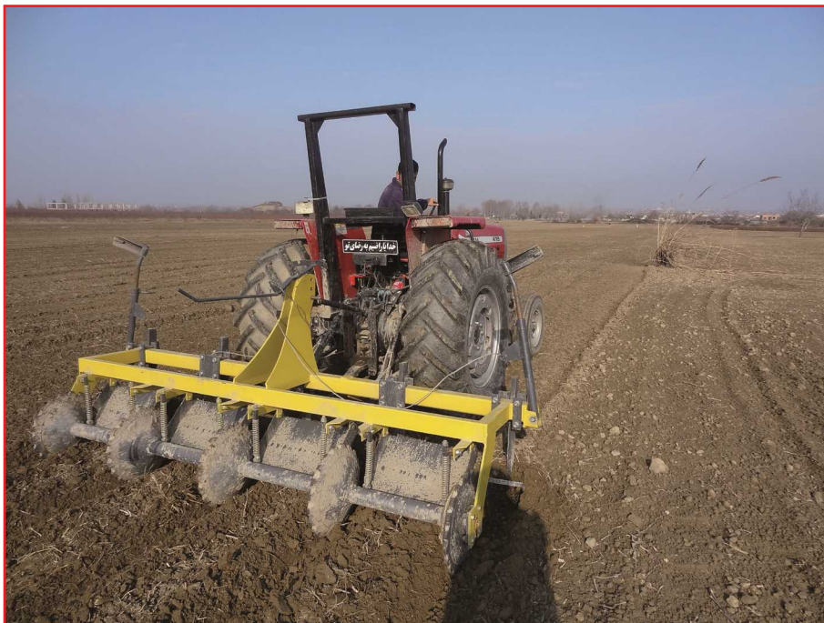
شکل ۸- فاروئر غلطکی که برای ایجاد بستر و شیار در بار اول در مزرعه از آن استفاده می‌شود.
