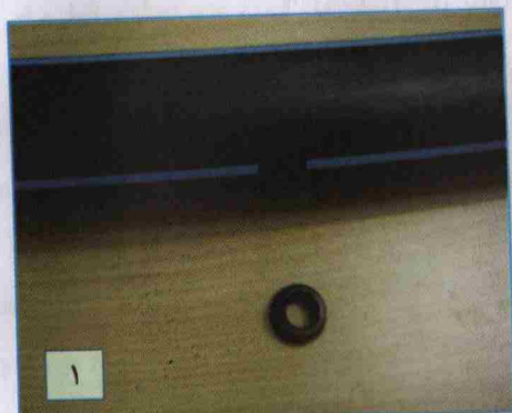
شکل ۱۱- نحوه انشعاب آب از لوله آب رسان پلی اتیلن ۶۳ میلی متری با واشر به لوله تیپ با انشعاب شیردار
