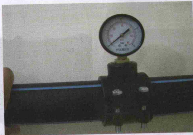
شکل ۱۷- فشار سنج در اندازه گیری فشار داخل لوله
