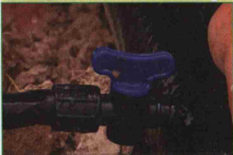
شیر انشعاب تیپ وصل شده به لوله اصلی
