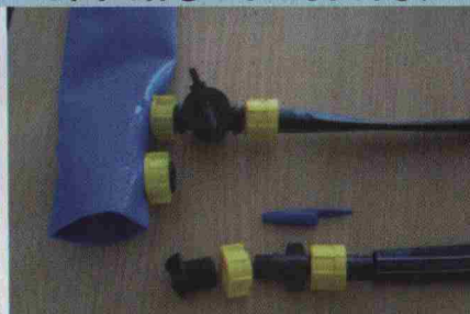
پانچ برای برش لوله اصلی نواری (نر) برای انشعاب
