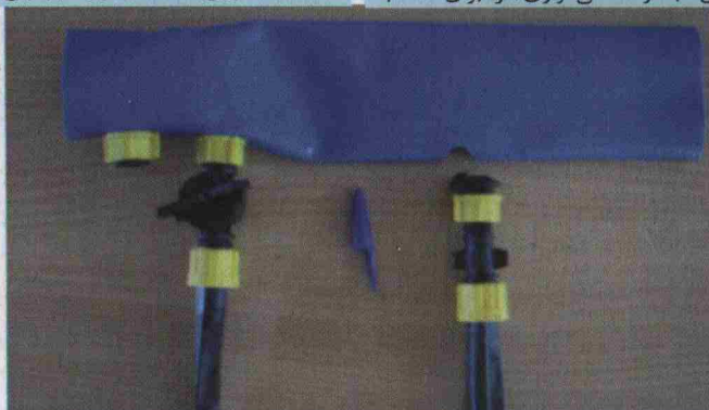
بست آماده و اتصال انشعاب به شیرهای اصلی تیپ
