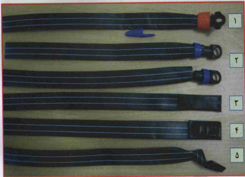
شکل ۱۳- حالت های مختلف بستن انتهای لوله تیپ
