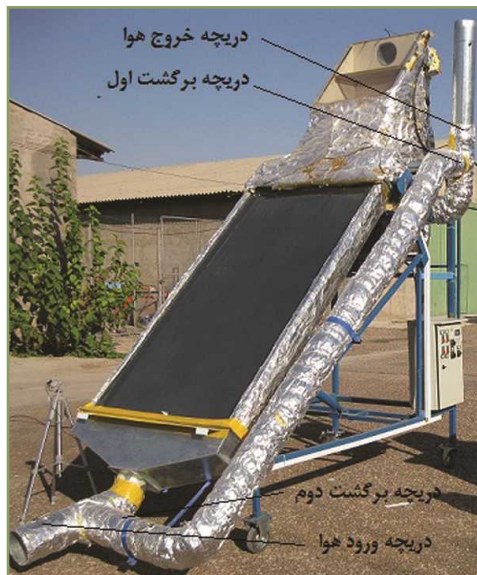
شکل ۱۳- خشک‌کن خورشیدی مجهز به سامانه برگشت هوای گرم خروجی
