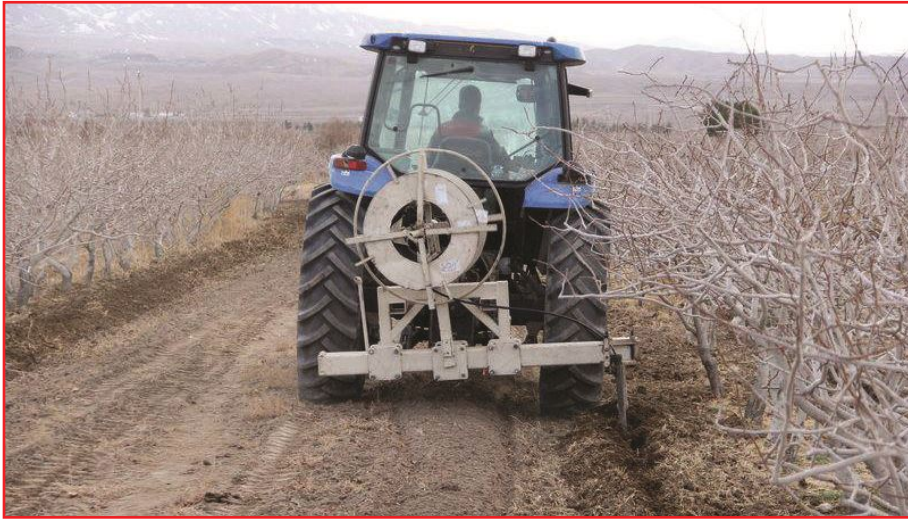
شکل ۳- مراحل حفاری و کارگزاری همزمان لوله‌های آبدی در باغ‌های پسته
