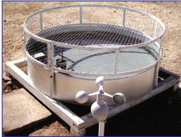
شکل ۶- تشتک تبخیر کلاس A برای تنظیم دور آبیاری در داخل مزرعه چغندر قند
