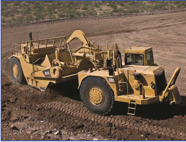
شکل ۱۴. اسپریگر برای شیب بندی زمین
