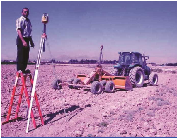
شکل ۱۵. دستگاه تسطیح لیزری
