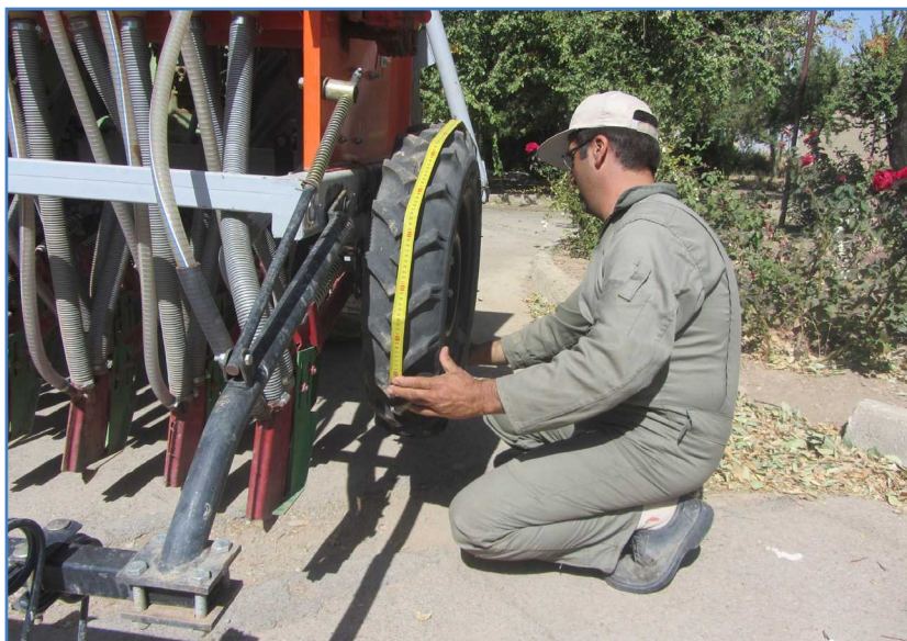
شکل ۶- اندازه‌گیری محیط یا درو چرخ بذرکار
