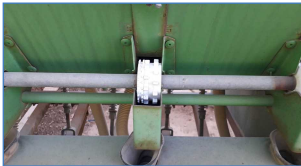
شکل ۱- موزع مخصوص غلات (بالا) و موزع مخصوص ریزدانه (پایین)
