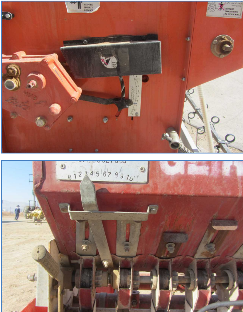
شکل ۴- اهرم تنظیم بذر در دو نوع بذرکار
