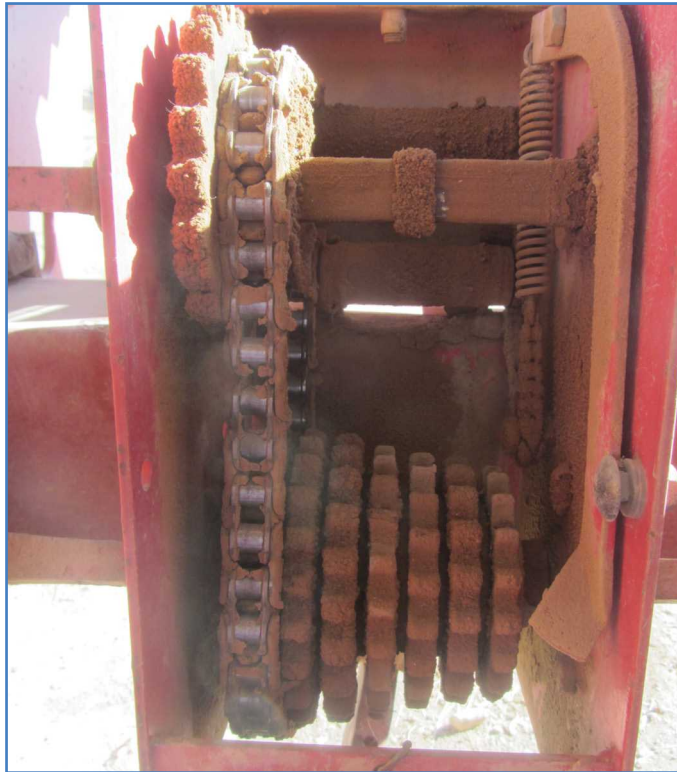
شکل ۱۳- با جابه‌جا کردن چرخ دنده‌ها می‌توان تراکم دلخواه را به دست آورد.
