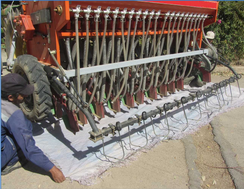
شکل ۸- استفاده از پارچه برزنتی یا پلاستیکی در صورت نبود سینی مخصوص واسنجی
