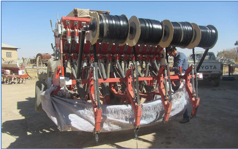
شکل ۱۰- استفاده پارچه کتان یا پلاستیک به منظور کالیبراسیون بذر کار محور گرد
