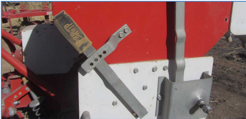
شکل ۵- اهرم تنظیم میزان بازبودن دریچه خروجی موزع در دو نوع بذر کار
